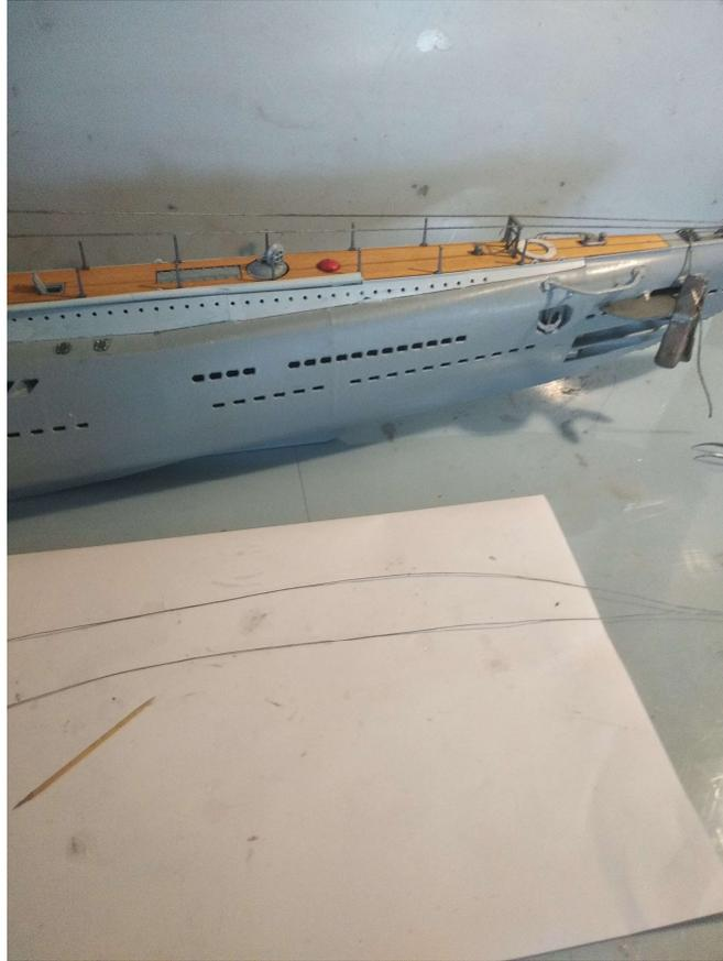
Reling vorne und hinten: 4mal 80cm Schnur 1mm Durchmesser, metallic eingefärbt (beigelegt).
